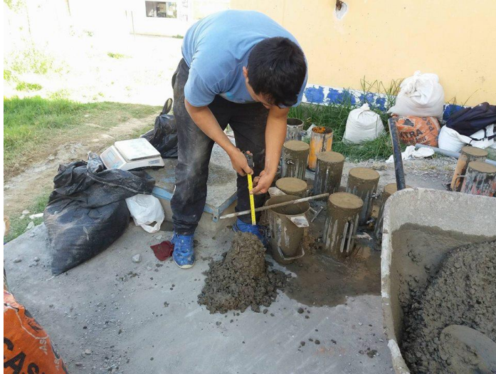
Foto N° 9 Realizando la prueba de asentamiento con el cono de Abrams
