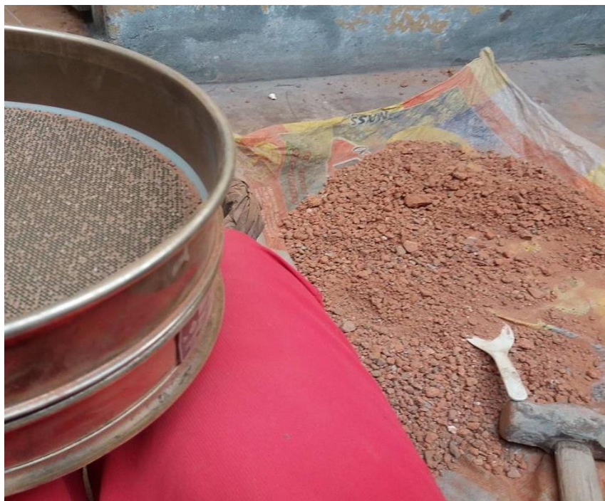
Foto N° 1 Recoleccion y triturado de los bloques residuales de arcilla
