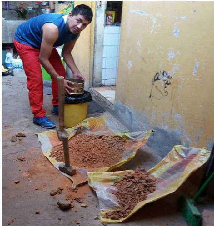
Foto N° 2 Triturando los bloques residuales de arcilla para tamizarlos por el tamiz N° 200
