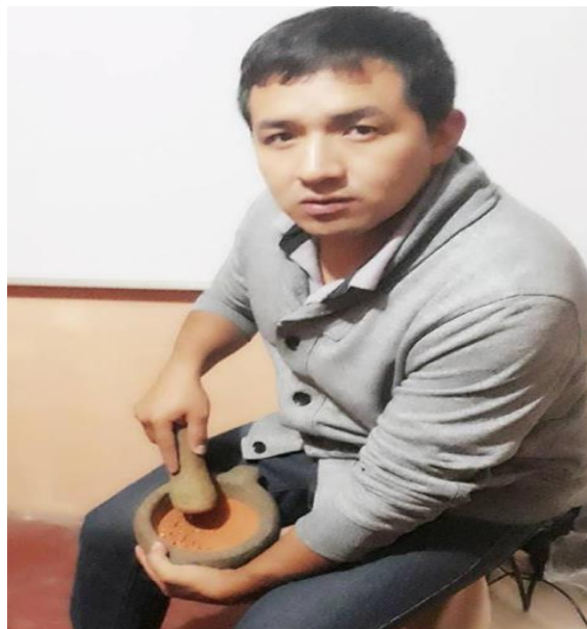
Foto N° 2 Triturando los bloques residuales de arcilla para tamizarlos por el tamiz N° 200
