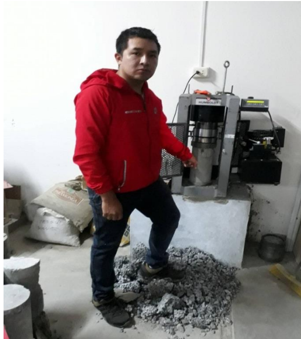
Foto N° 8 Realizando los ensayos de rotura de probetas y tomándose anotación
