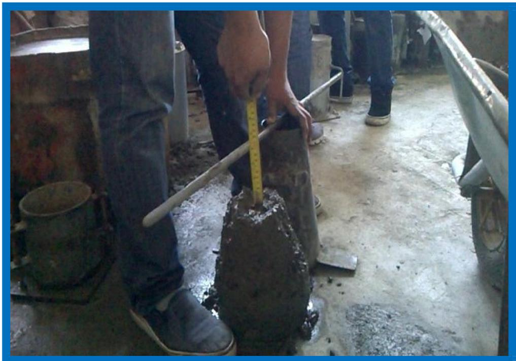
**FOTO N° 12: Midiendo el grado de compactación, mediante la prueba del Slump**
