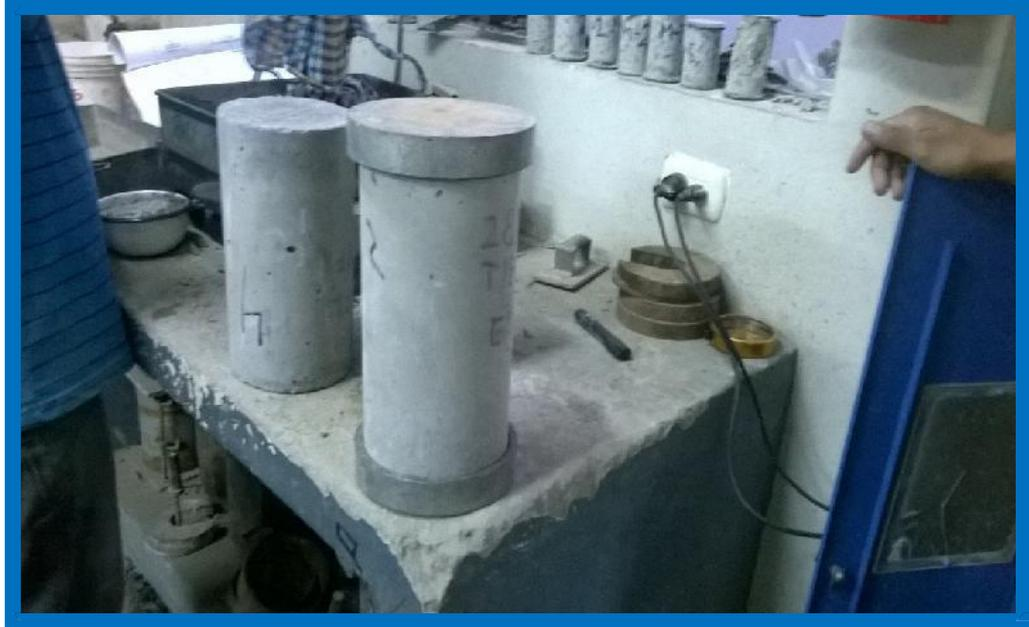
**FOTO N° 13: Preparando las muestras curadas en agua de mar para realizar el ensayo a compresión.**
