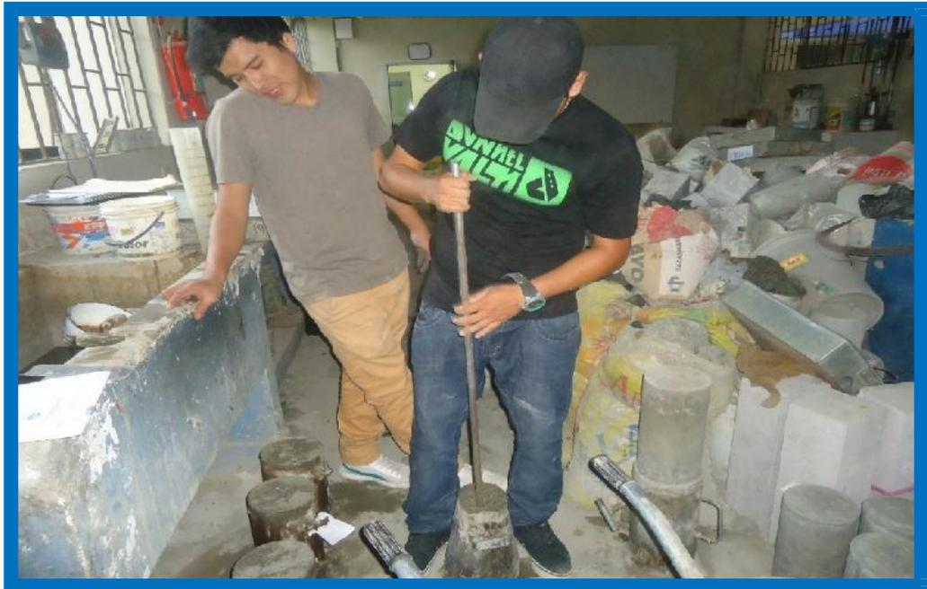
**FOTO N° 11: Realizando la compactación del concreto con la varilla; y el cono de Abrams.**
