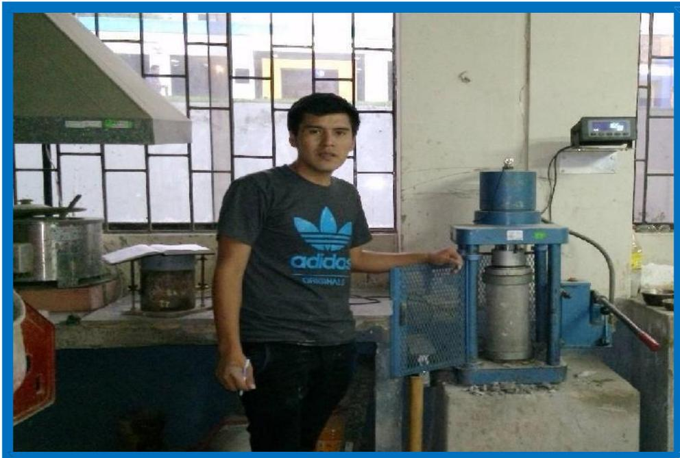
**FOTO 16:** Realizando ensayos a compresión de probetas curadas en agua de mar.
