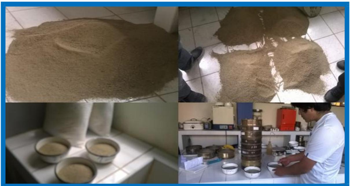
**FOTO N° 04: Granulometría de la arena; realizando el cuarteo para reducir nuestra muestra representativa a un tamaño conveniente para los ensayos; como el tamizaj**
