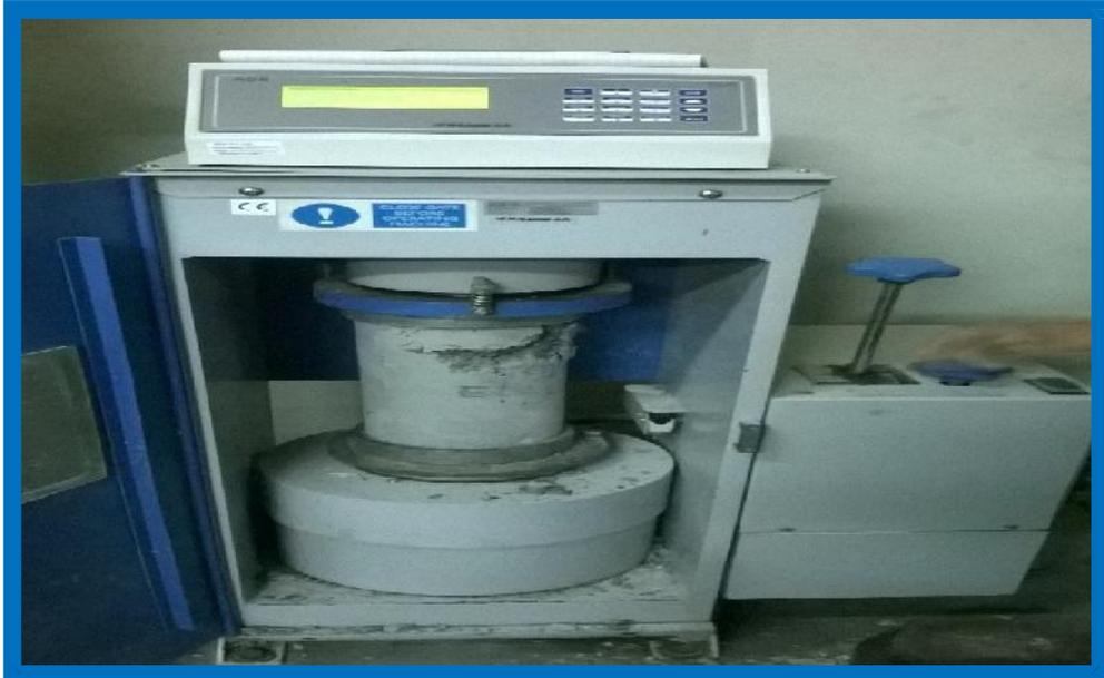
**FOTO N<sup>o</sup> 15:** Realizando ensayos a compresión de probetas curadas en agua potable.
