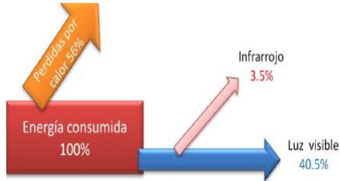
Figura N° 02. Balance energético de una lámpara de vapor de sodio a alta presión.
