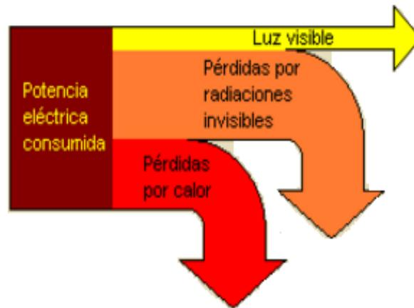
Fig. N° 14. Composición de potencia eléctrica consumida.
