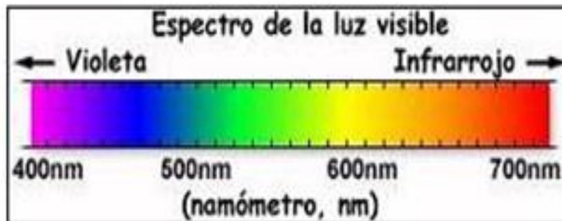
Fig. N° 10. Clasificación del Espectro Visible.
