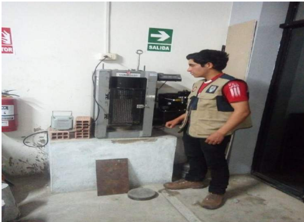
Fotografía 20: Ensayo resistencia a la compresión
