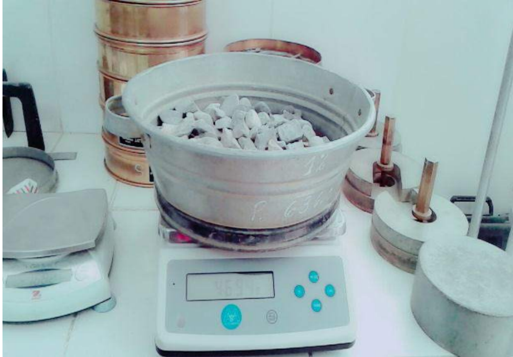
Fotografía 7: Pesado de agregado fino.
