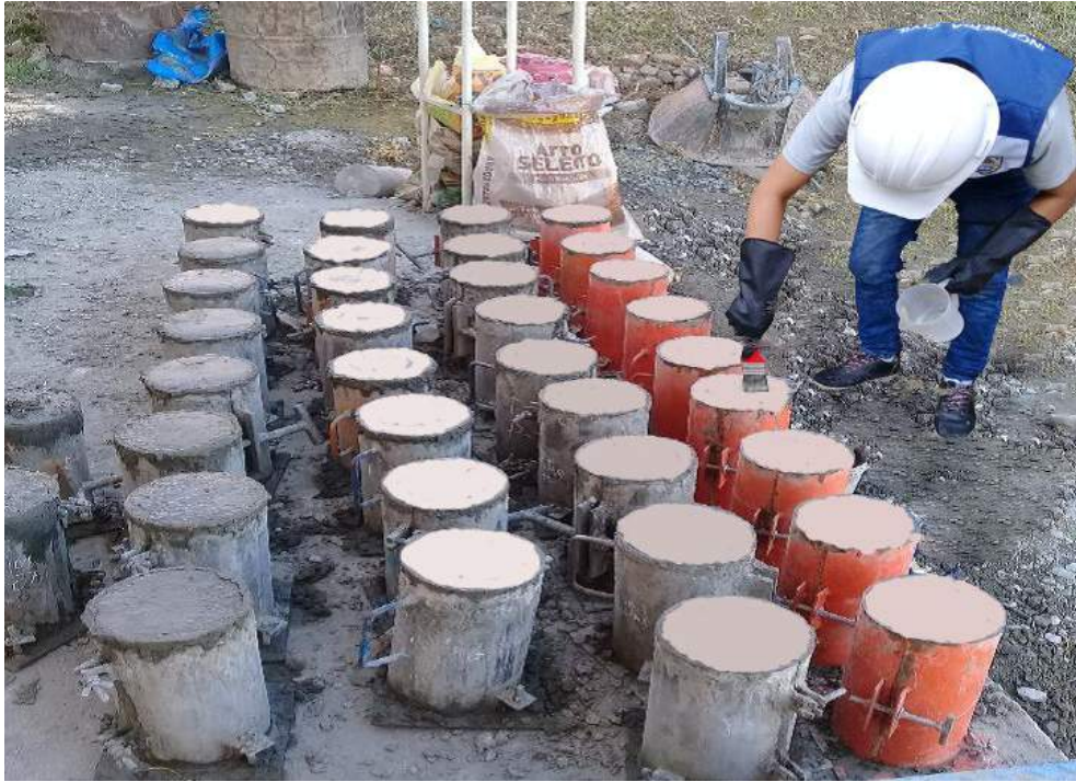
Fotografía 17: Curado de las probetas a 100 minutos después del vaciado.
