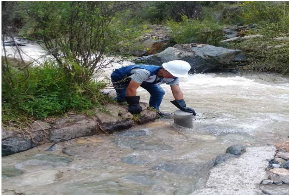
Fotografía 20: Curado de probetas con agua Rio Llacash.
