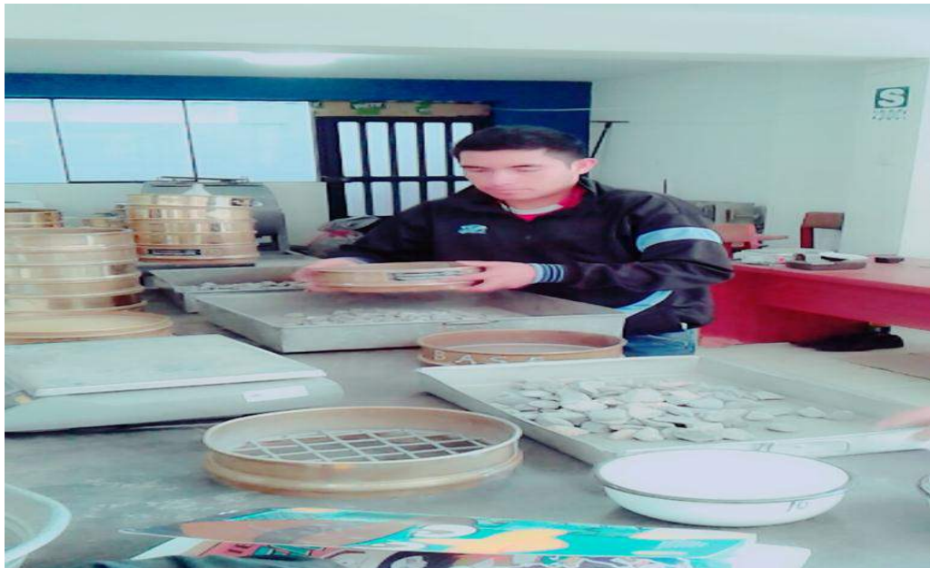
Fotografía 8: Proceso de tamizado de agregado grueso.
