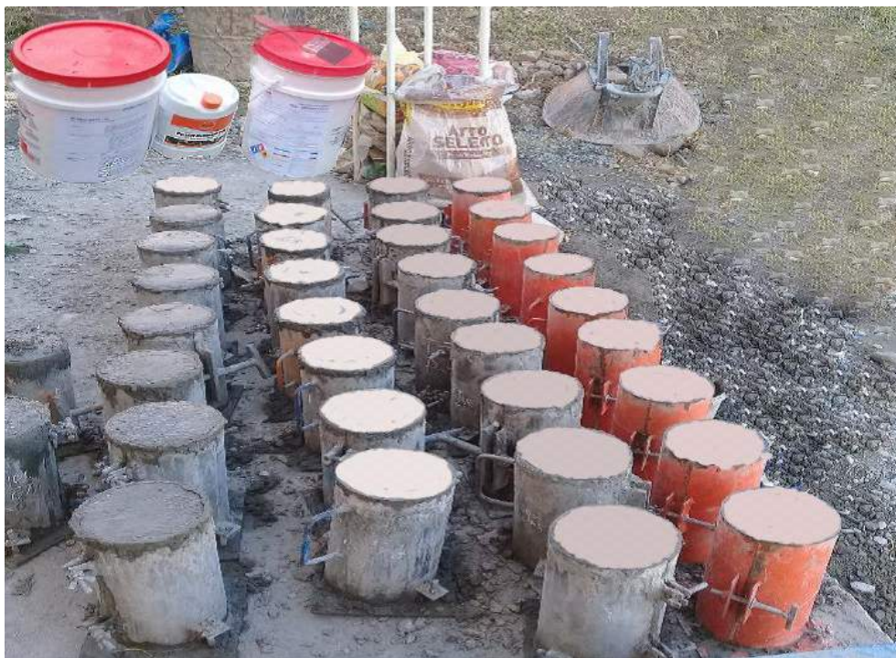
Fotografía 16: Curadores formadores de Membrana (Kurencrete 50, Membranil Vista y Per Membrana R).
