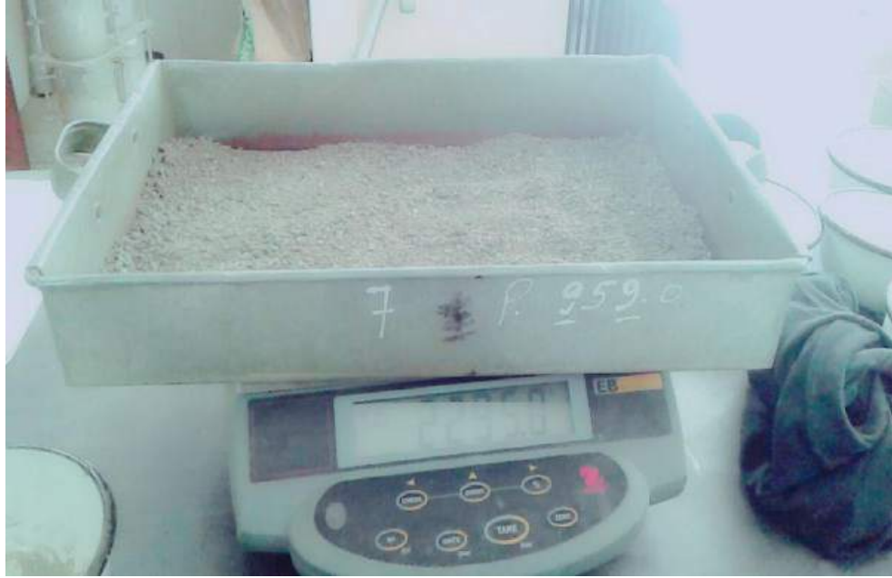
Fotografía 9: Pesado de agregado fino.
